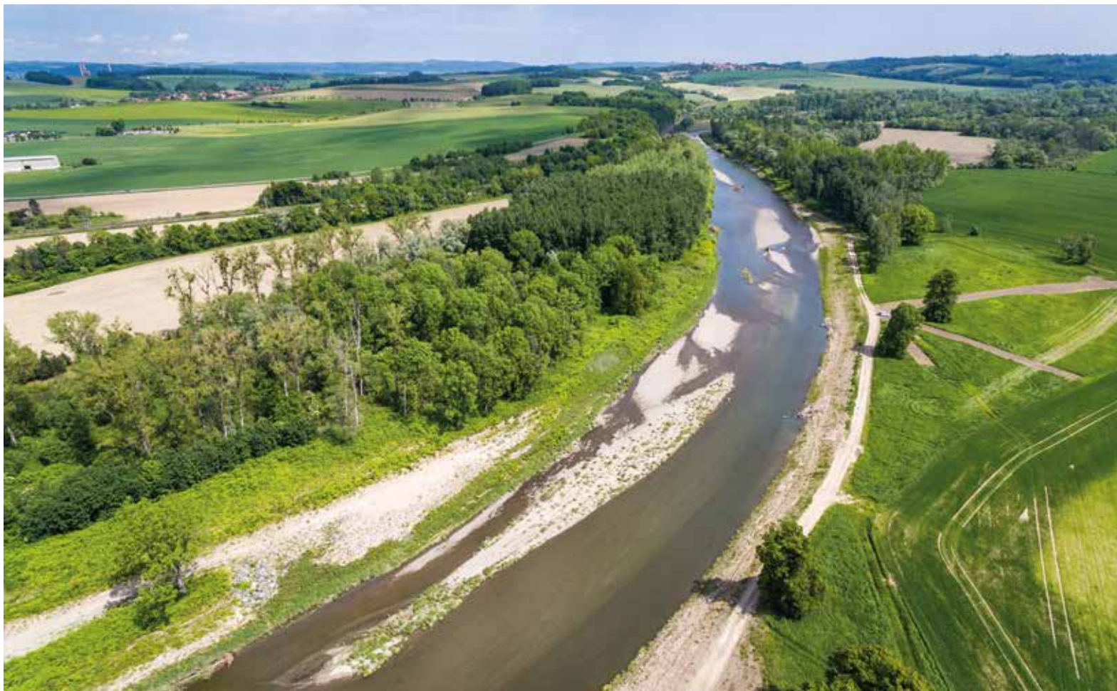
Obr. 3. Rozvolnění řeky Bečvy umožnilo vzniknout štěrkovým lavicím (Zdroj: Povodí Moravy)
