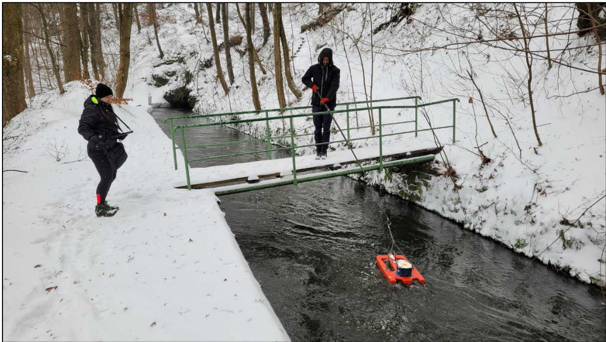
Obr. 1. Měření průtoků pomocí ADCP přístroje RDI StreamPro na Weissshunově náhonu v Žimrovicích dne 8. ledna 2024 (foto: J. Unucka)
