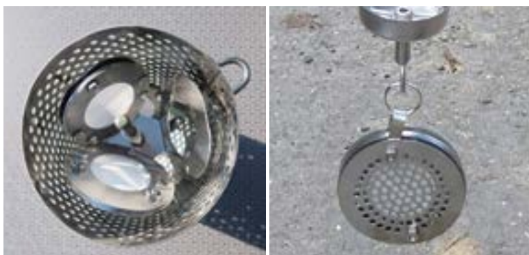
Obr. 5. Pasivní vzorkovač typu POCIS ve velkém koši (vlevo) a v chráničce (vpravo) Fig. 5. Passive sampler POCIS in big canister (left) and in the casing (right)
